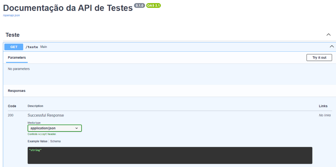
Figura 5 – Exemplo de documentação gerada pelo framework FastAPI que detalha uma rota específica
