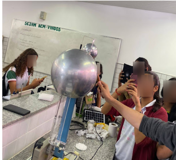
Imagem 5 - Descarregamento do gerador, tocando a cúpula menor na maior após as folhas sofrerem ação do campo elétrico
