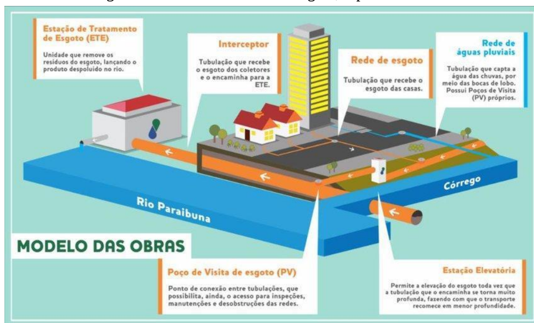
Figura 28 - Sistema coletivo de esgoto, separador absoluto
