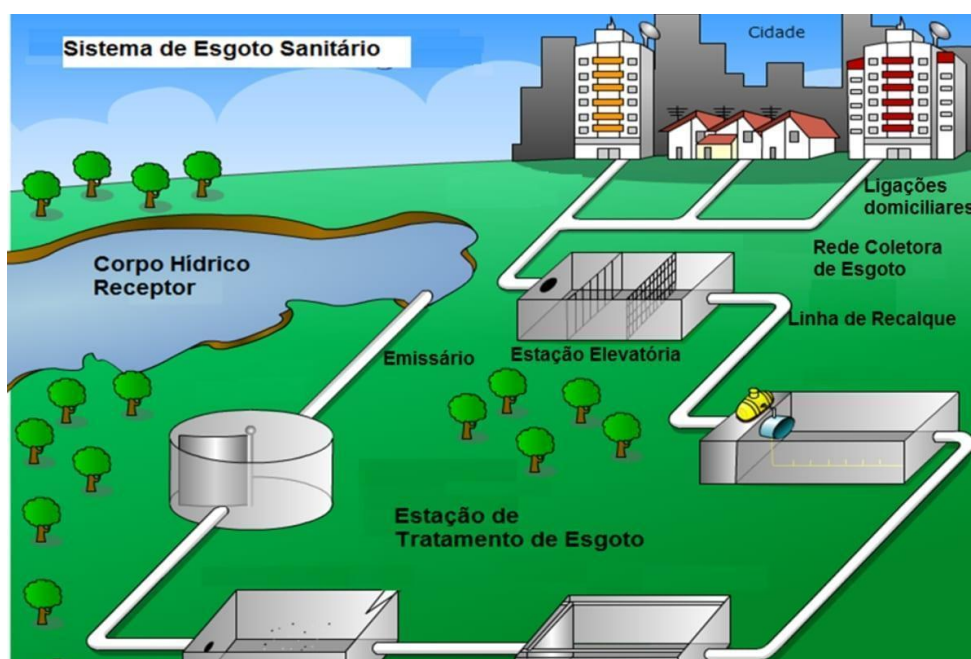
Figura 6 - Etapas do Serviço de Esgotamento Sintetizada
