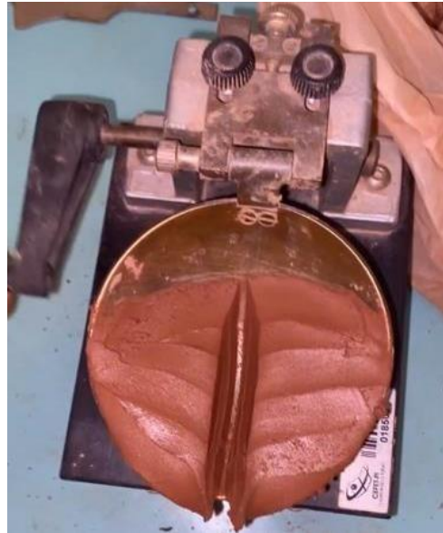
Figura 7 – Ensaio de Casagrande
