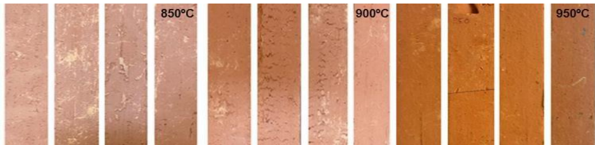
Figura 20 – Resultado da análise macroestrutural para formulação F1
