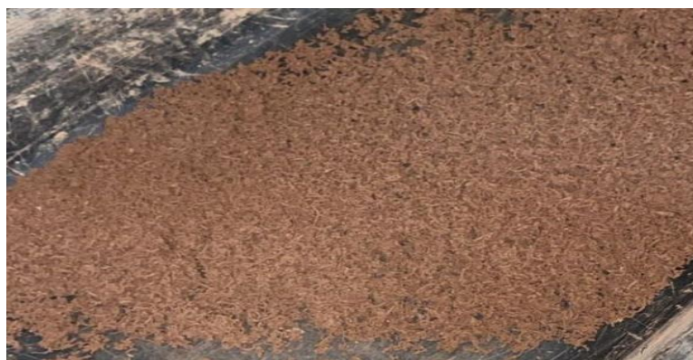
Figura 8 – Mistura das argilas umidificadas
