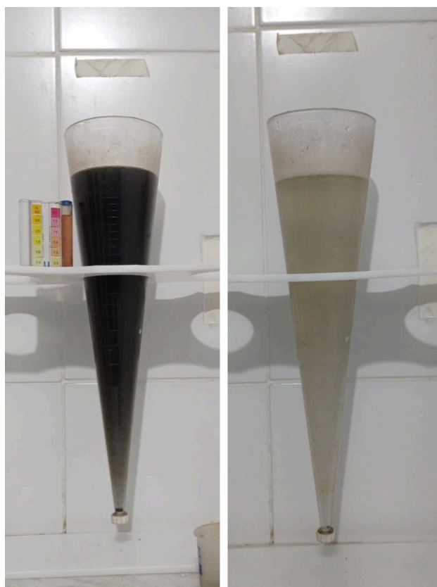
Figura 3 - Comparativo do efluente após descarte final dos tanques e após o filtro de polimento
