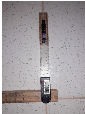
Figura 05 – Junção do segundo laser com o transferidor digital.
