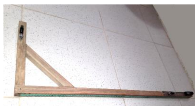
Figura 02 – Comparação da inclinação da base de madeira com linhas formadas por um piso de cerâmica.
