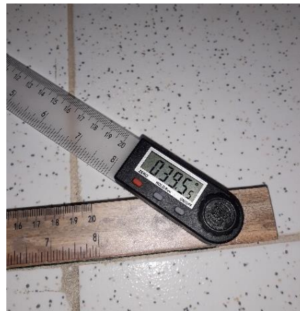
Figura 04 – Transferidor digital colado a haste de madeira marcando um ângulo qualquer.
