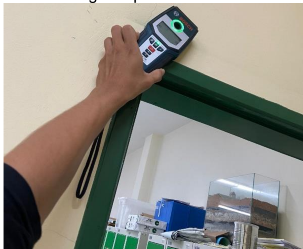
Figura 23 – Ausência de verga na porta da sala de estudo dos professores.
