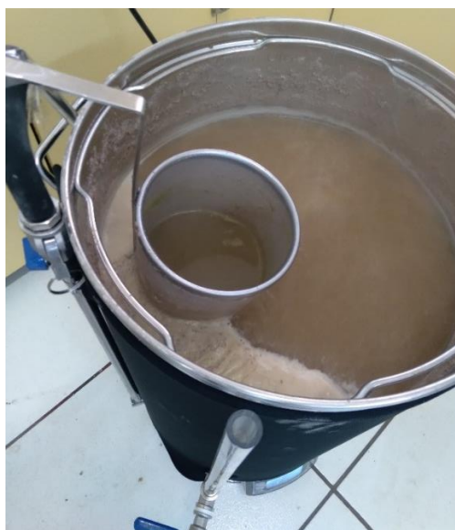
Figura 11: Lúpulo adicionado ao mosto por meio do cesto hop spider .
