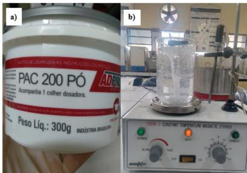
Figura 9: Sanitização. a) solução à base de Ácido Peracético, b) preparação do sanitizante no agitador magnético.
