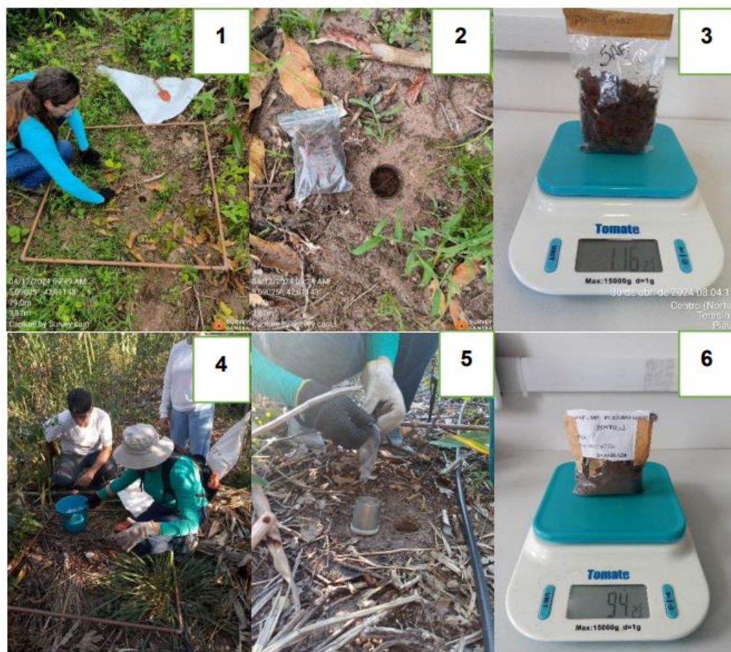
Figura 3 - Coleta das amostras de densidade (anel volumétrico 93,03cm 3 ).
