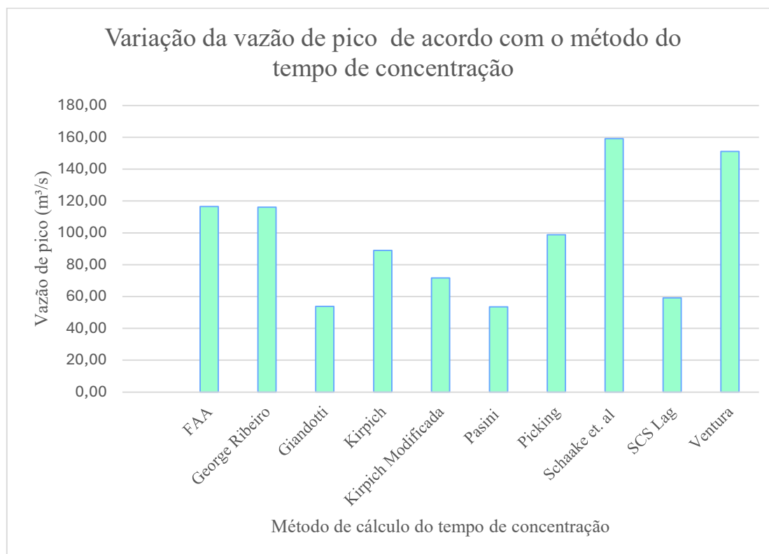
Figura 64 - Variação da vazão de pico de acordo com a metodologia de cálculo do tempo de concentração
