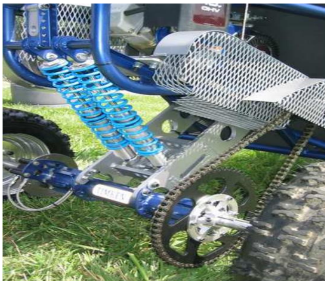
Figura 14 - Transmissão de potência por corrente de rolos
