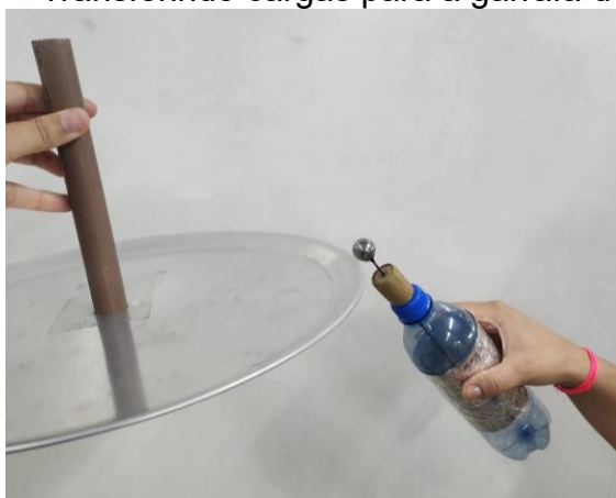
Figura 20 – Transferindo cargas para a garrafa de Leiden.
