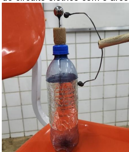
Figura 22 – Momento do circuito elétrico com o arco e a garrafa de Leiden.
