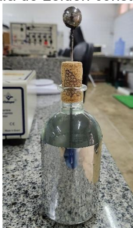
Figura 23 – Réplica da Garrafa de Leiden construída com recipiente de vidro.
