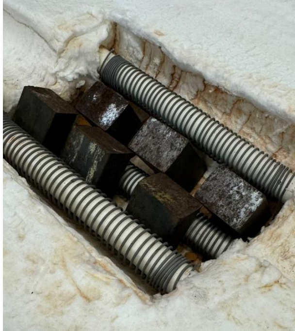
Figura 13 – Corpos de prova submetidos a recozimento
