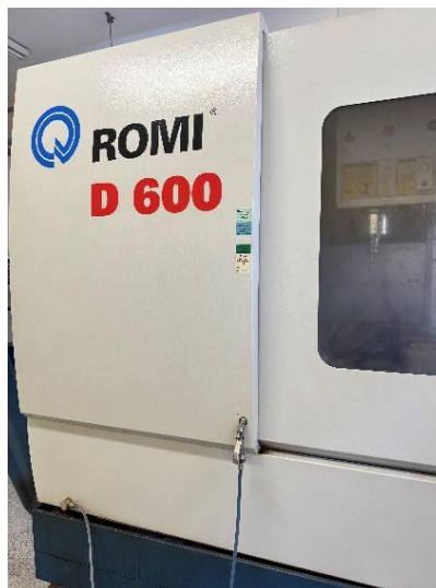
Figura 14 – Máquina de Comando Numérico Romi D 600
