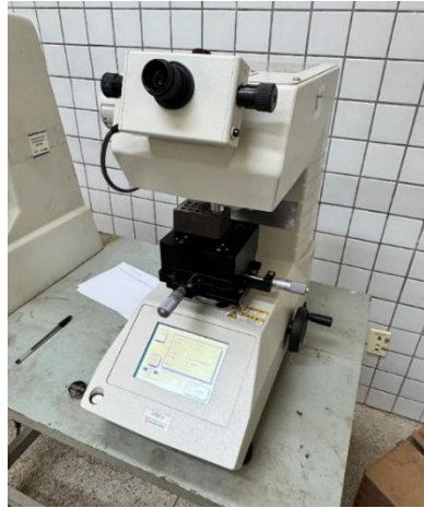
Figura 20 – Microdurômetro Shimadzu MHV-2T
