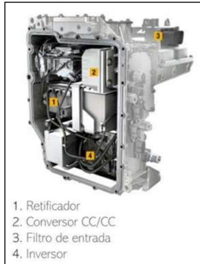
Figura 11 - Partes internas do inversor de frequência
