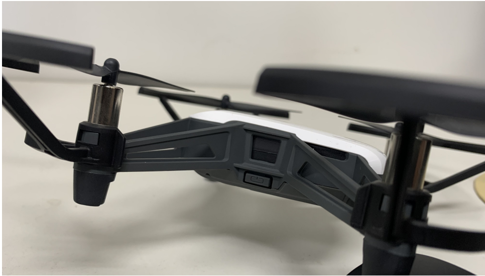
Figura 14 – Localização do botão Power da aeronave
