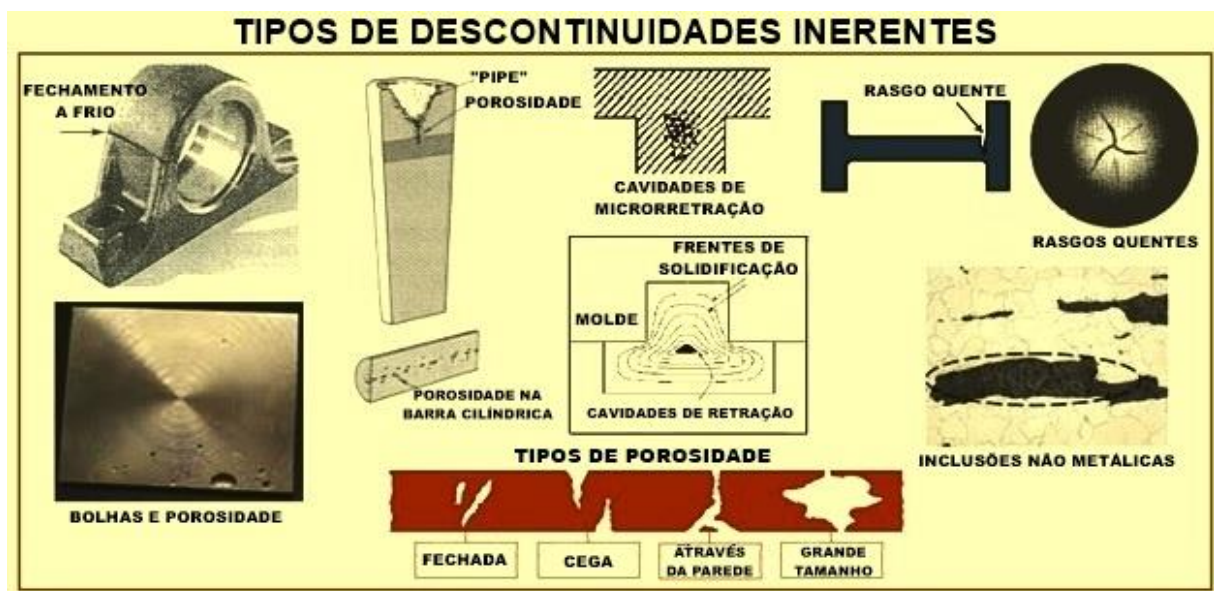
Figura 1 - Tipos de Descontinuidades Inerentes
