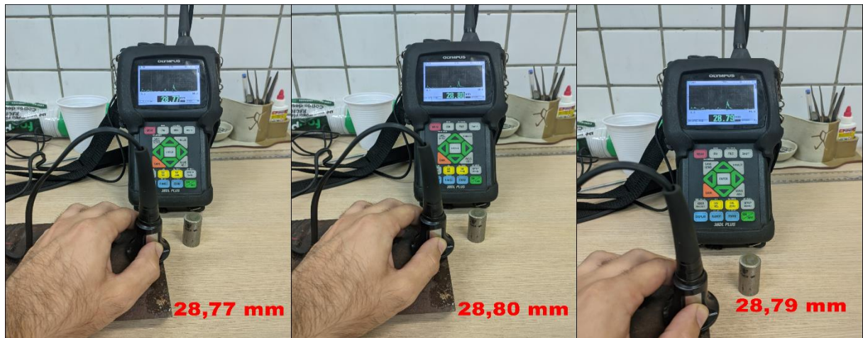
Figura 19 – Resultados das medições de espessura por US na região superior do ensaio
