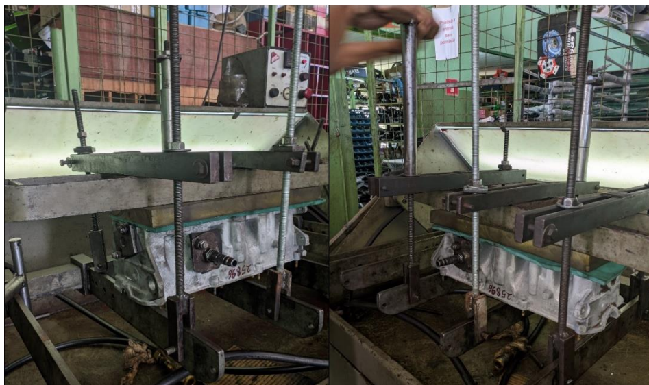
Figura 13 – Posicionamento do corpo de prova no Teste de Trincas em Cabeçote
