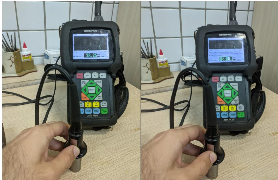
Figura 10 – Calibração do equipamento com bloco de teste
