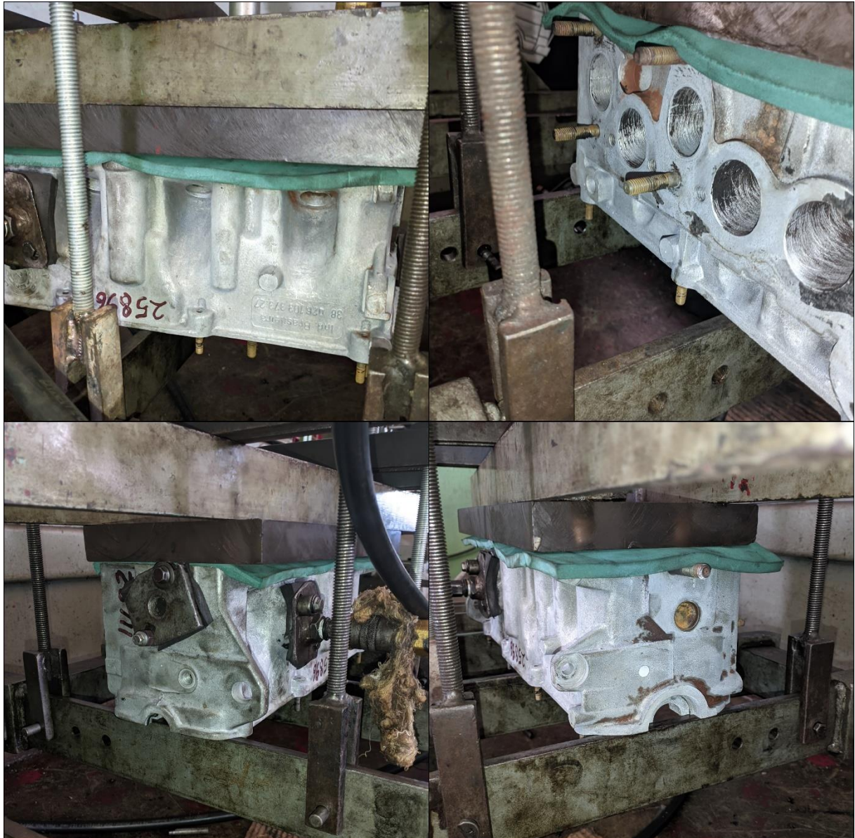
Figura 22 – Superfícies externas do cabeçote após Teste de Trincas
