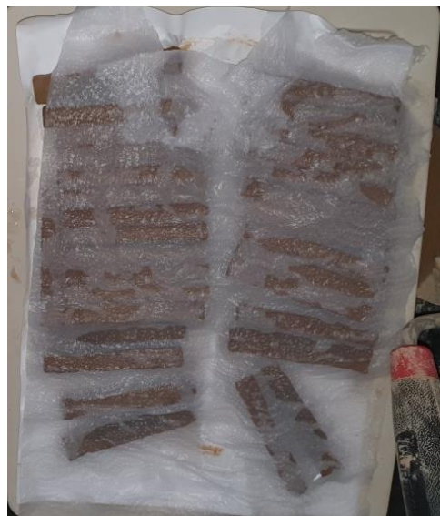
Figura 10: Cura sob toalhas úmidas
