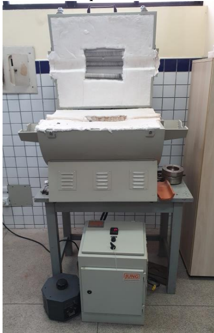
Figura 13: Forno utilizado no ensaio de queima
