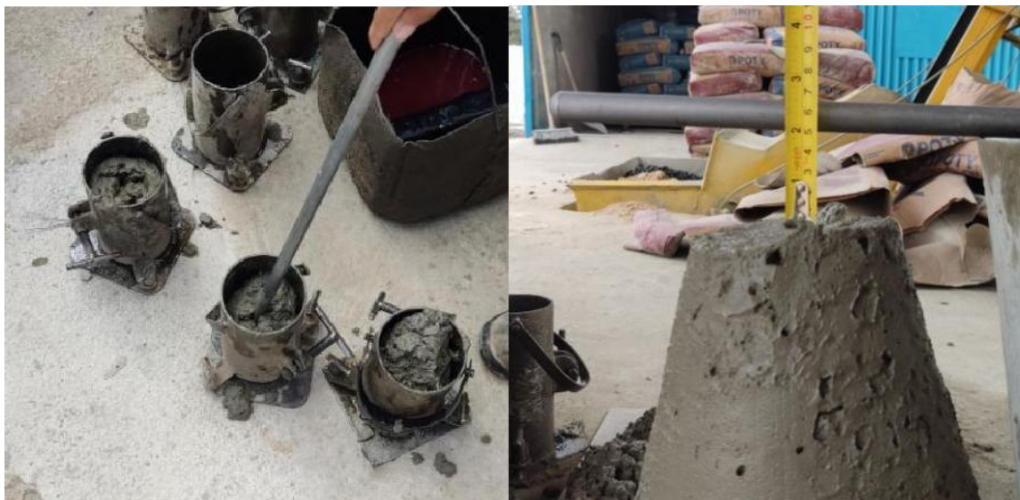
Figura 14: Slump teste e confecção de corpos de prova (CP's)
