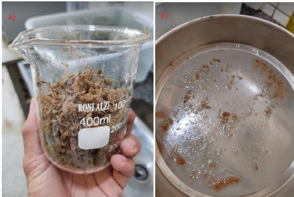
Figura 7: Fibras kraft extraídas.
