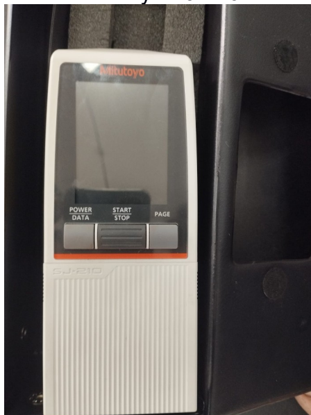
Figura 10: Rugosímetro Mitutoyo SJ-210
