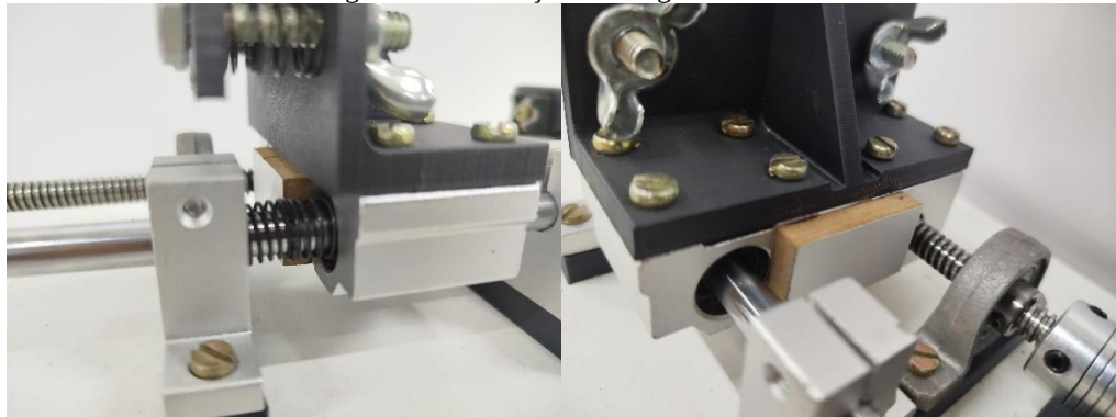
Figura 50 – Correções de folgas do trilho.
