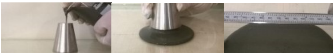
Figura 21 – Etapas do ensaio: molde sendo preenchido com a pasta; momento do levantamento do minicone e aferição do diâmetro formado.
