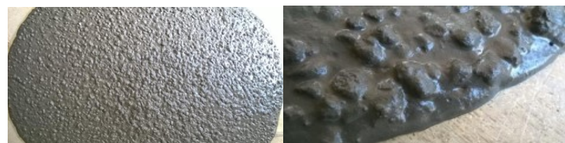
Figura 32 – Aspecto do CAA CCA15%; detalhe das bordas.
