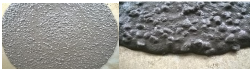
Figura 31 – Aspecto do CAA CCA10%; detalhe das bordas.
