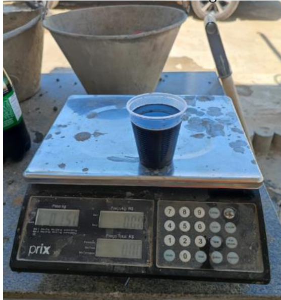
Figura 14 – Aditivo utilizado na dosagem do concreto.
