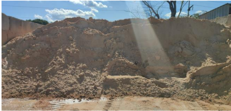
Figura 3 - Massará após o processo de lavagem.
