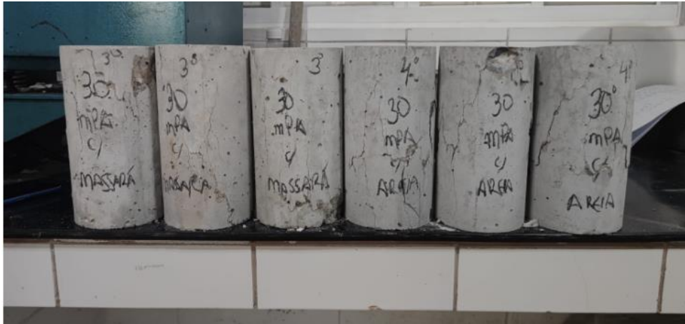
Figura 31 – Corpos de provas após ruptura.
