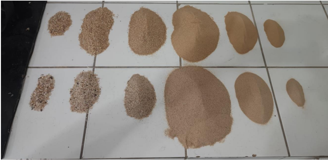
Figura 4 - Análise granulométrica do massará e da areia.
