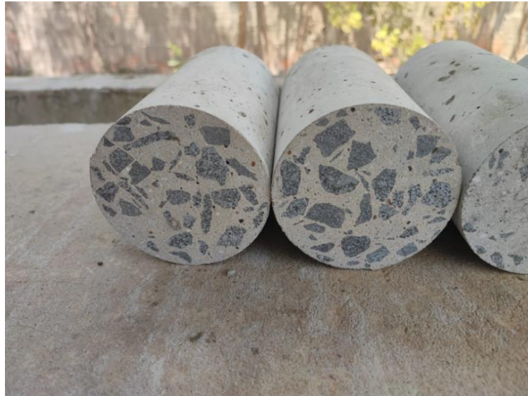
Figura 27 – Corpos de prova com bases niveladas.
