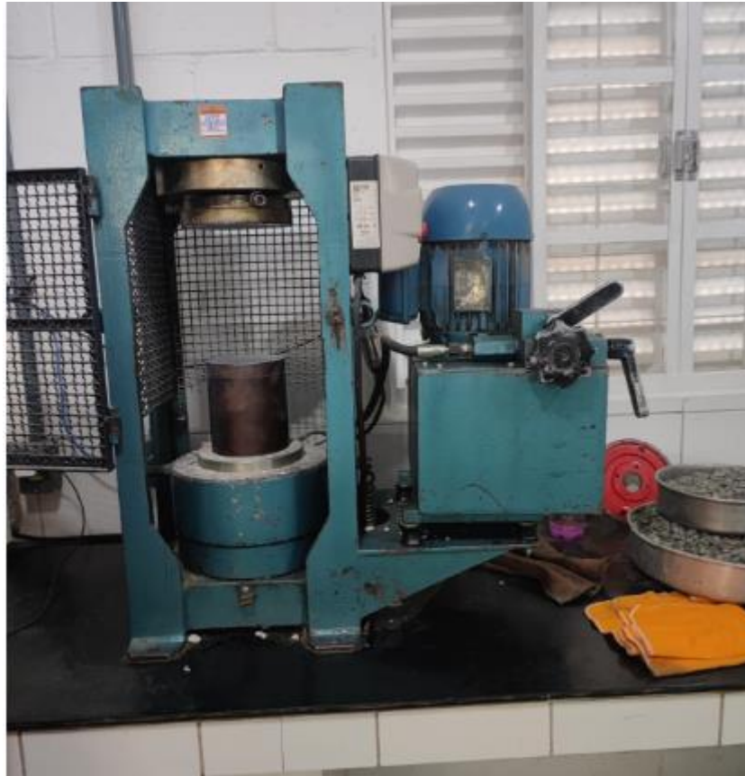
Figura 28 – Prensa para ruptura dos corpos de prova.
