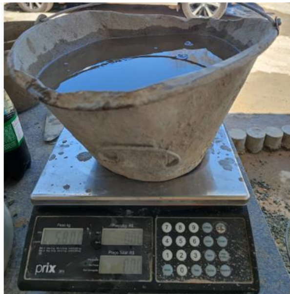
Figura 13 - Água utilizada na dosagem do concreto.
