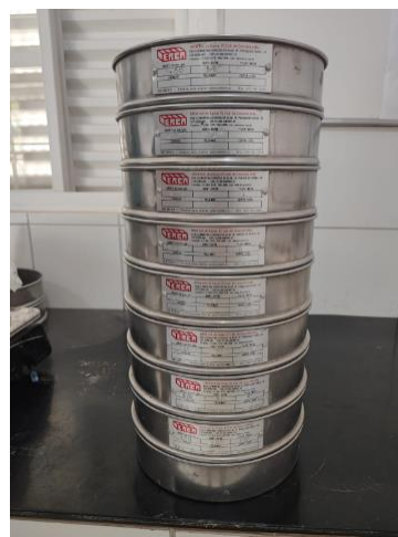
Figura 5 - Jogo de peneiras usado para a análise granulométrica.
