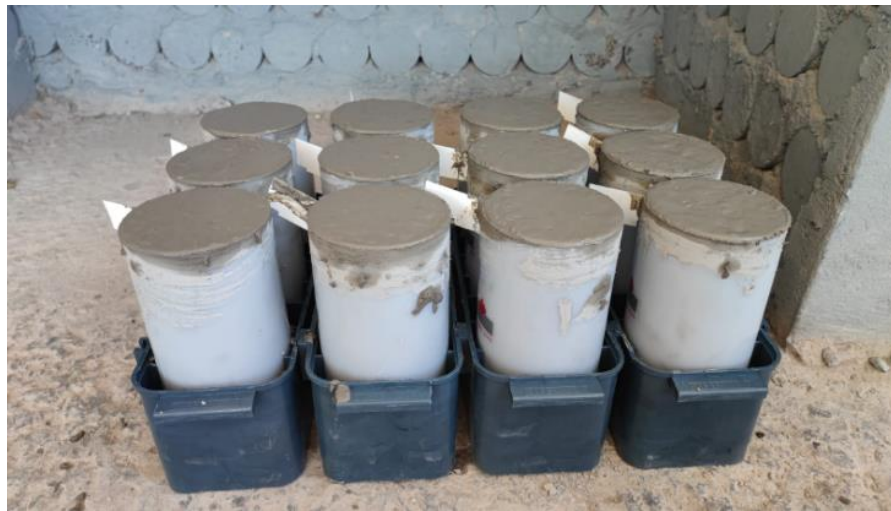
Figura 22 – Corpos de prova após moldagem.
