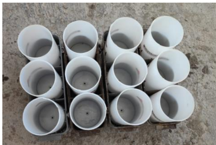
Figura 21 – Forma cilíndrica para moldagem dos corpos de prova.
