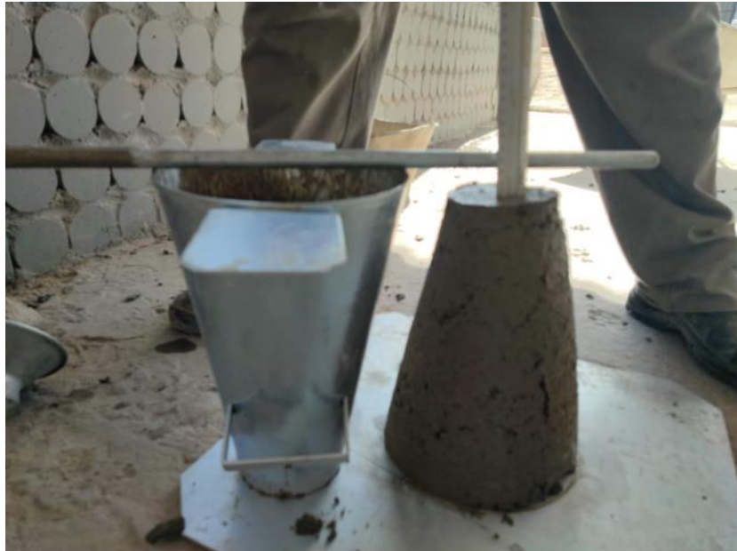
Figura 19 – Ensaio do abatimento do tronco de cone Slump Test.
