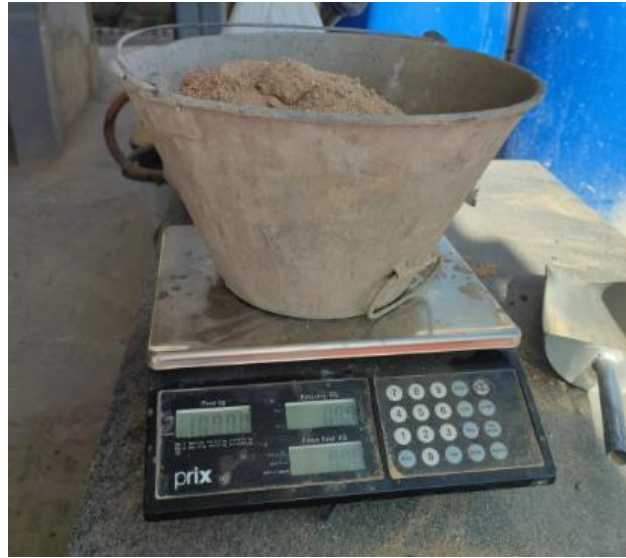
Figura 12 - Massará lavado utilizado na dosagem do concreto.
