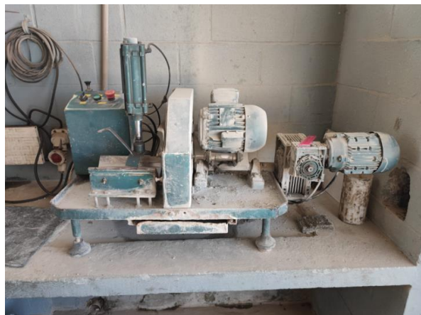
Figura 26 – Mesa niveladora dos corpos de prova.
