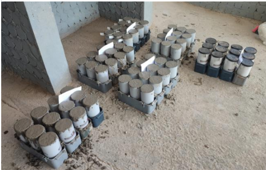
Figura 23 – Corpos de prova após moldagem.
