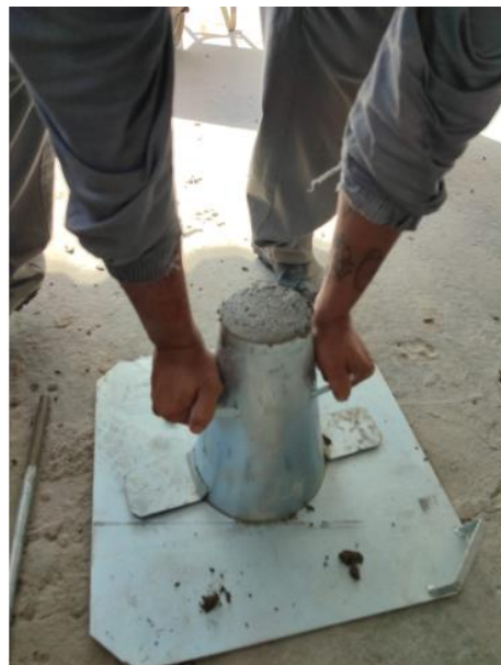
Figura 18 – Ensaio do abatimento do tronco de cone-Slump Test.
