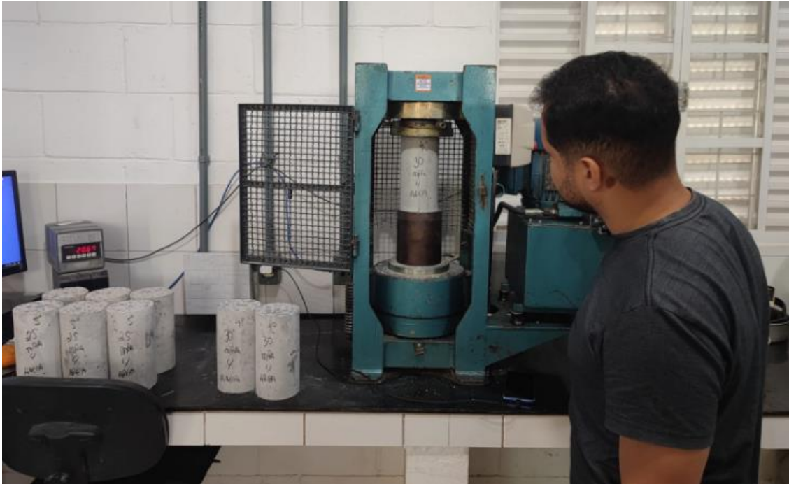
Figura 29 – Corpo de prova submetido à compressão axial na prensa.
