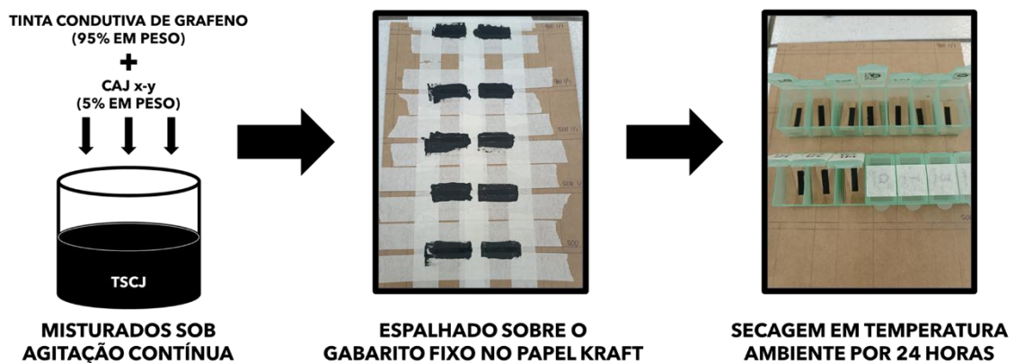
Figura 05 - Processo de fabricação do eletrodo de CAJ pelo processo de serigrafia.
