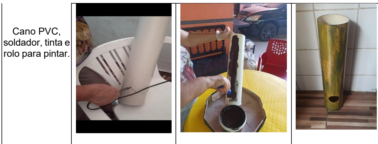
Quadro 1 – Detalhamento da fabricação de um puxa saco.
