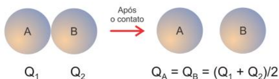
Figura 9 - Ilustração do processo de eletrização por contato de duas esferas idênticas
