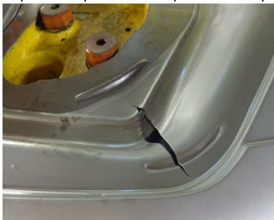
Figura 3 - Exemplo de Ruptura em Chapa Metálica após Estampagem
