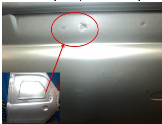
Figura 5 - Deformação Superficial em Peça Estampada
