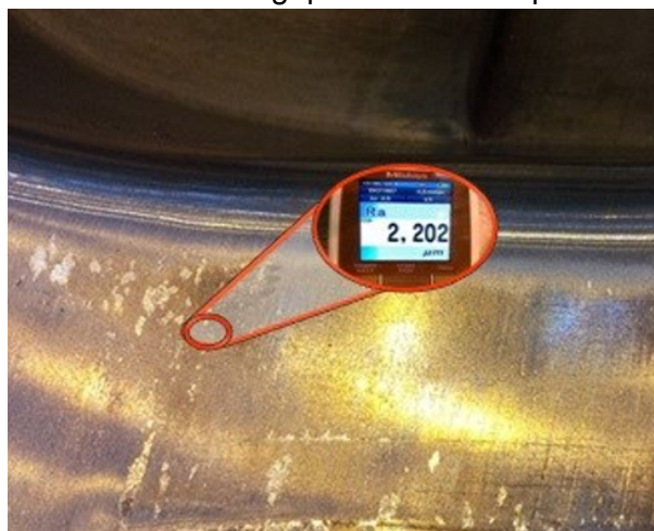
Figura 4 - Defeito de Engripamento em Superfície Metálica
