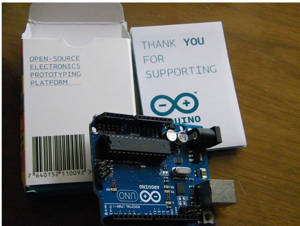
Figura 1 – Placa Arduino Uno R3 e seus principais componentes
