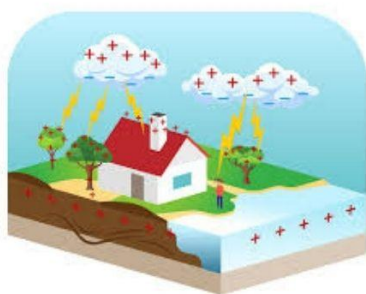
Figura 4 - Formação de raio por eletrização
