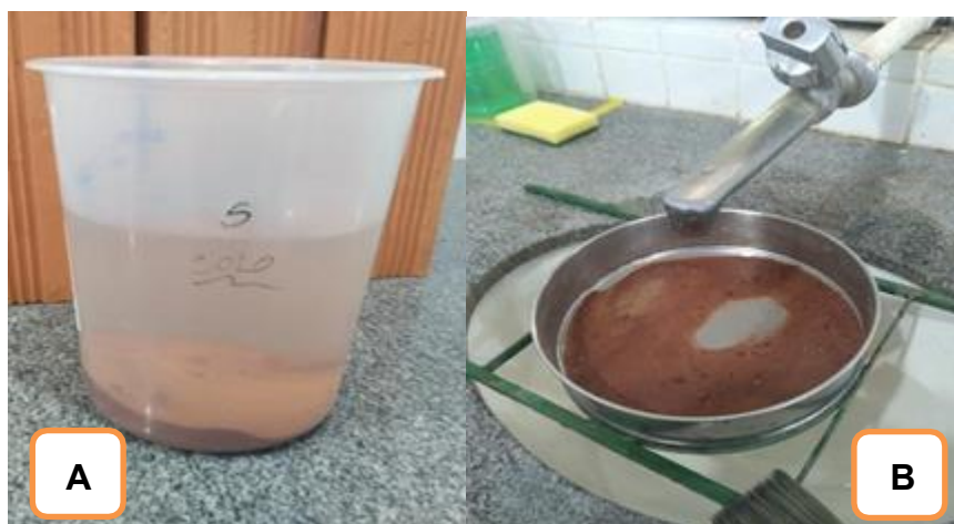
Figura 7 - Análise residual do solo: solo em repouso por 24 horas (A); processo lavagem utilizando peneira (B)
