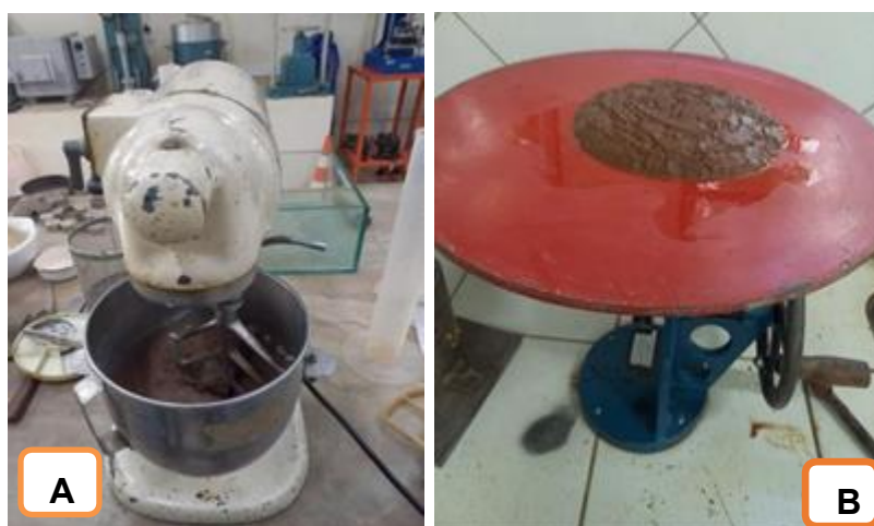
Figura 10 - Misturador mecânico (A); Consistência da argamassa utilizando a mesa de consistência(B).
