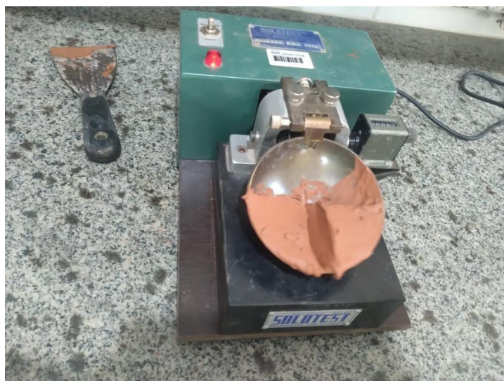
Figura 8 - Execução do ensaio de Casagrande.
