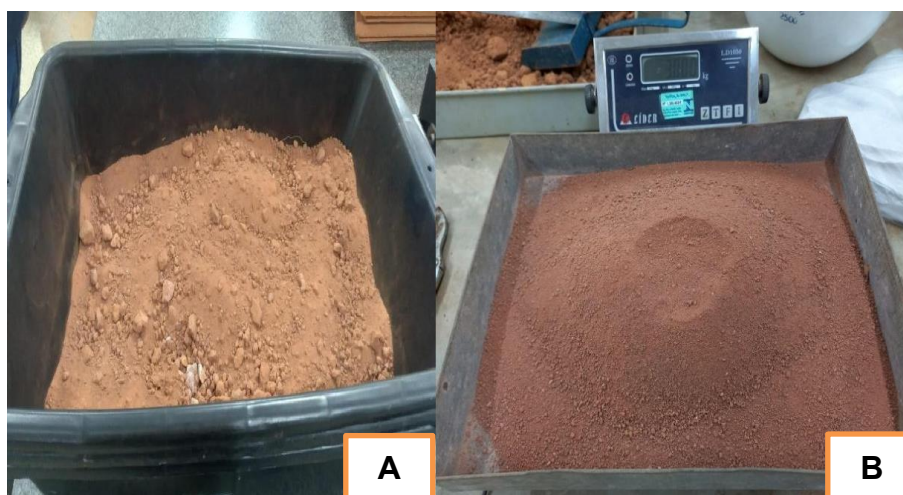
Figura 5 - Ensaio de caracterização de solo: Preparo da amostra (A); Fração fina do solo obtida após peneiramento (B)
