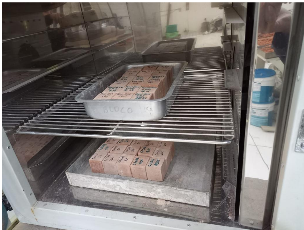
Figura 16 - Secagem dos corpos de prova em estufa a 110 °C por 24 horas para determinação da massa
