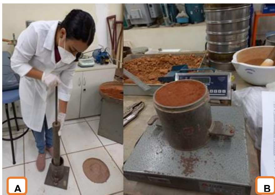
Figura 9 - Compactação do solo: cilindro de compactar o solo com um soquete (A), solo compactado (B)
