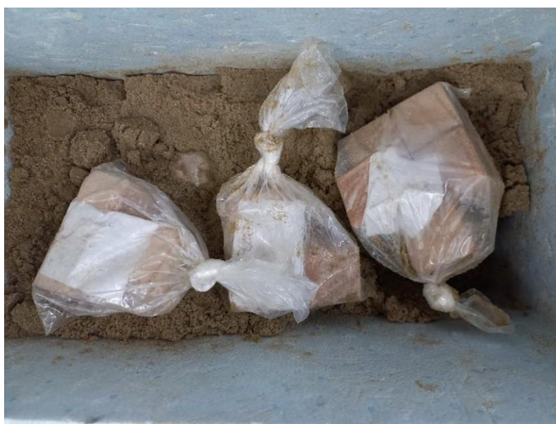
Figura 14 - Cura úmida dos corpos de provas
