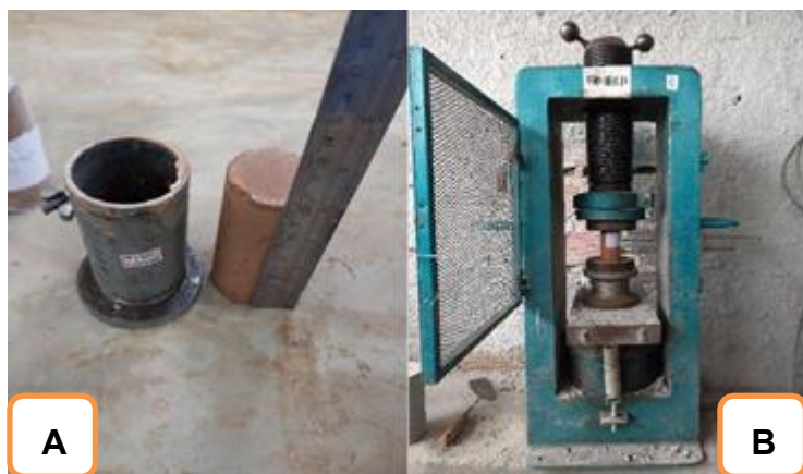
Figura 12 - Desmolde do corpo de prova (A); Rompimento dos corpos de prova (B)
