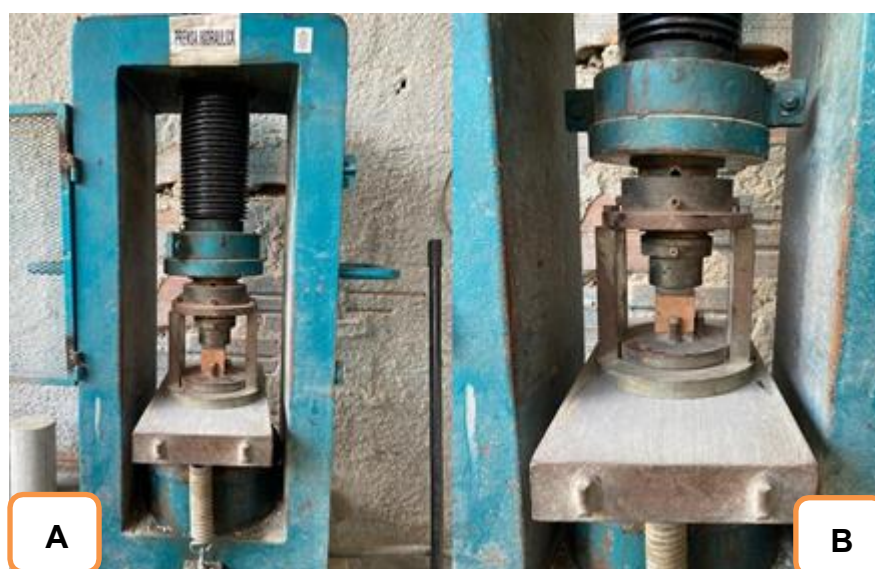
Figura 17 - Ensaio de compressão dos corpos de prova: (A) antes e (B) durante a ruptura.
