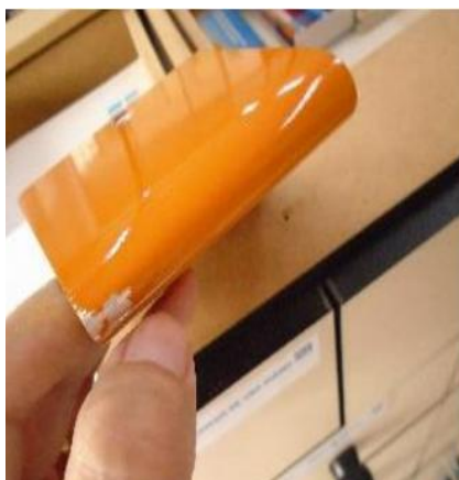
Figura 6- Exemplo de defeito em pintura por falta de aderência
