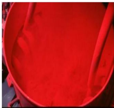
Figura 5 - Exemplo de defeito em pintura por baixa fluidização.
