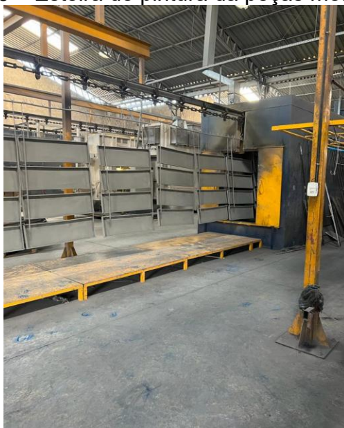
Figura 3 – Esteira de pintura da peças metálicas.
