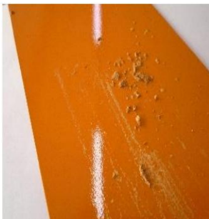
Figura 7- Exemplo de defeito em pintura por conta de golfada de pó.
