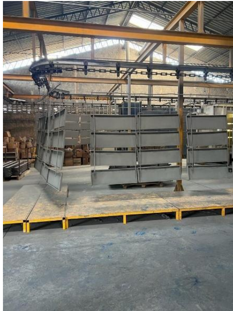
Figura 26 – Esteira de pintura das peças metálicas.
