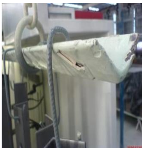
Figura 8- Exemplo de defeito em pintura por conta de gancheira suja
