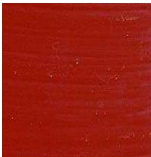
Figura 9- Exemplo de defeito em pintura por conta de pontos salientes.
