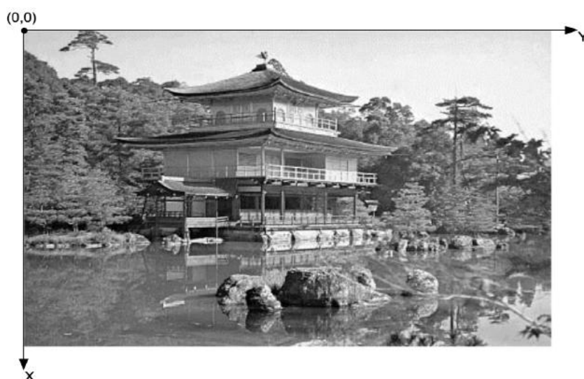
Figura 21 – Imagem em escala de cinza e a convenção utilizada para o sistema de coordenadas (x,y).
