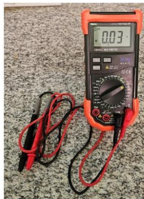
Figura 10: Conexão das pontas de prova no voltímetro
