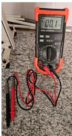
Figura 11: Conexão das pontas de prova no amperímetro
