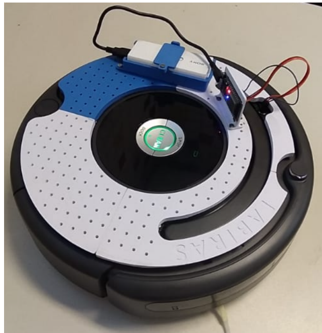
Figura 24 – Roomba montado com ESP 32, bateria e a base para adição de sensores variados
