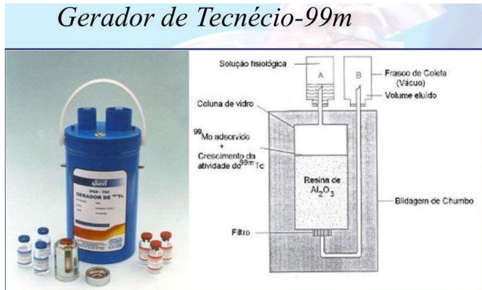
Figura 2: imagem mostrando um gerador de molibdenio-99/tecnécio-99m
