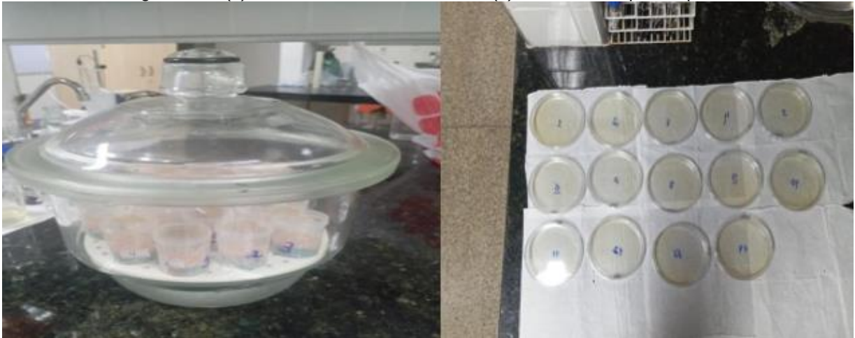
Figura 12 – (a) Dessecador com 15 células; (b) 15 filmes em placas petri.
