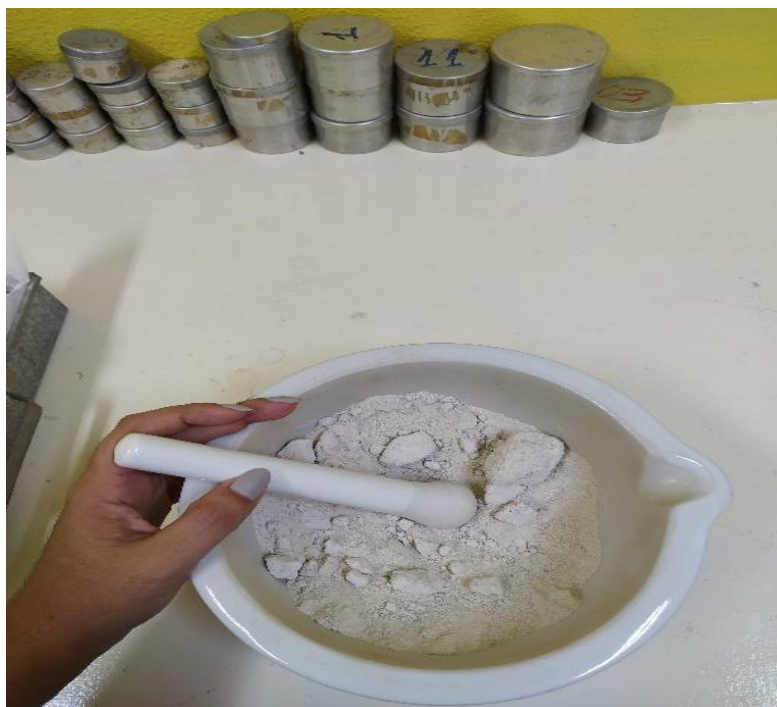
Figura 10- Destorroamento manual após a secagem.
