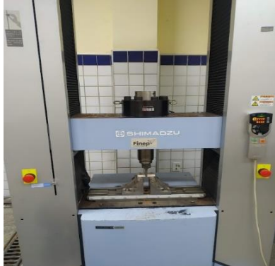
Figura 13- Máquina de ensaios universal, modelo AG – I 250KN.
