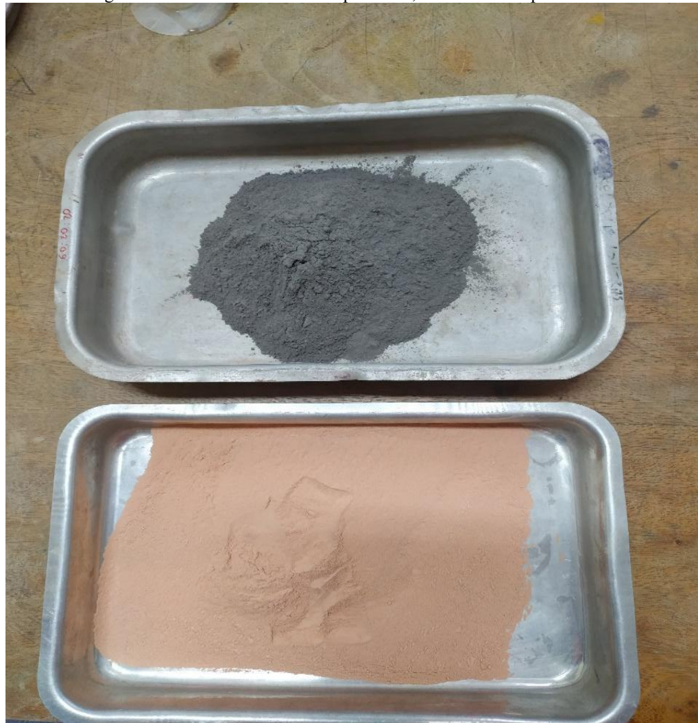
Figura 12- Amostras CFL e CPR após secas, destorroadas e peneiradas.
