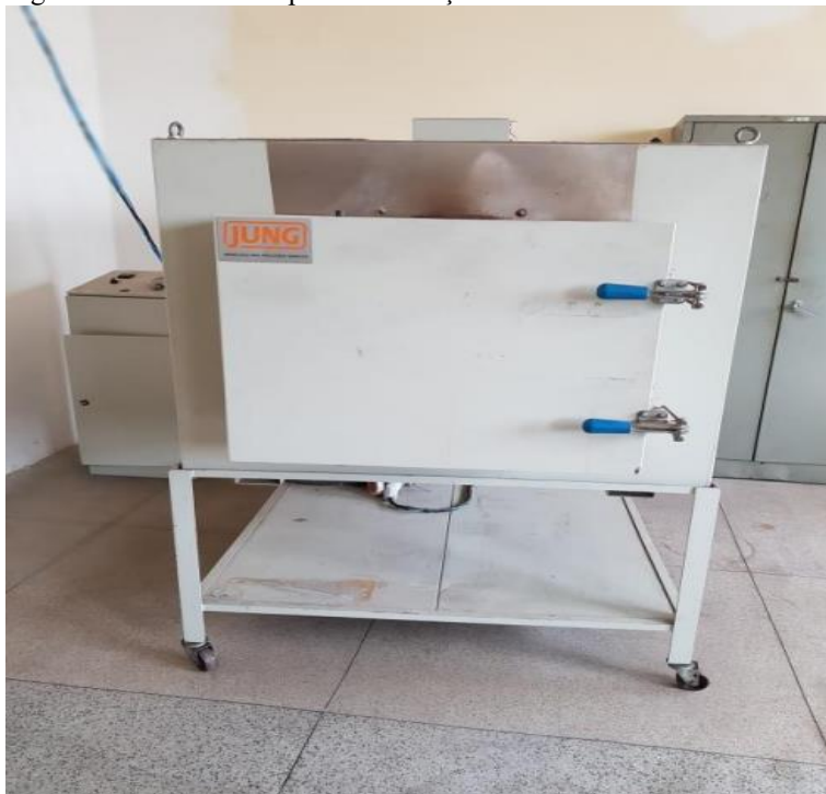
Figura 23- Forno usado para sinterização das amostras.
