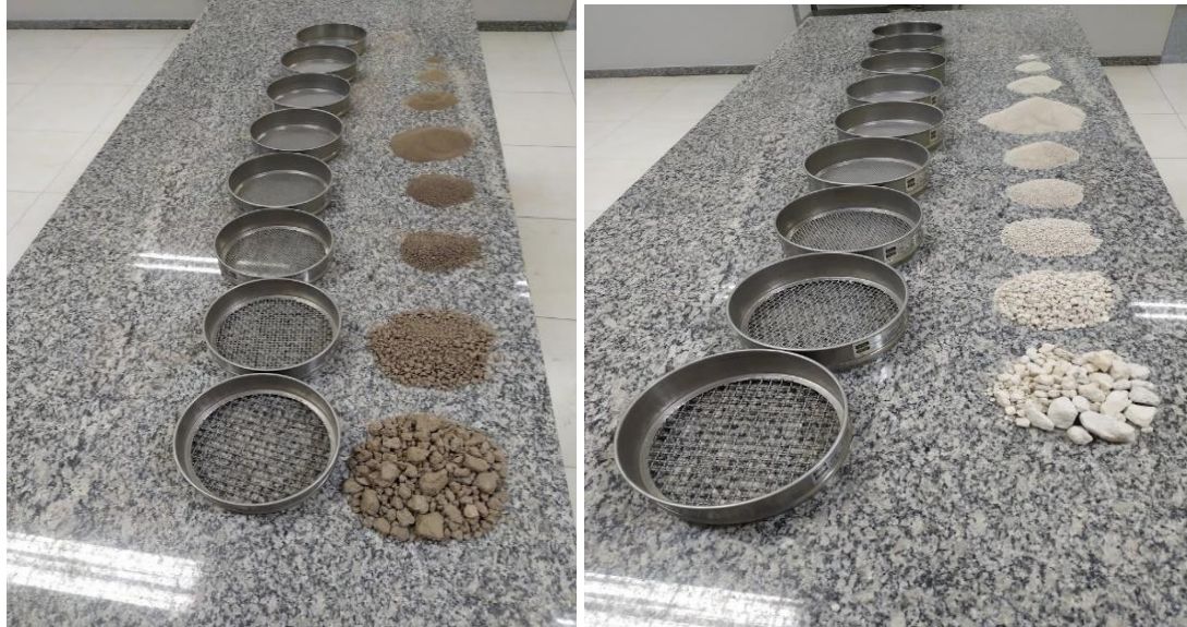
Figura- 15 e 16- Ensaio de Peneiramento amostras CFL e CCX1.
