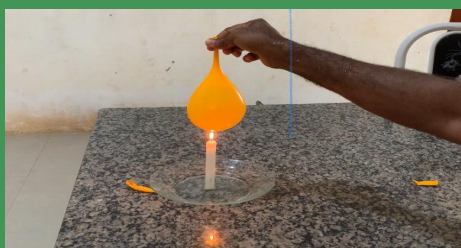
Figuras 22. Balão com água que não queima com fogo
