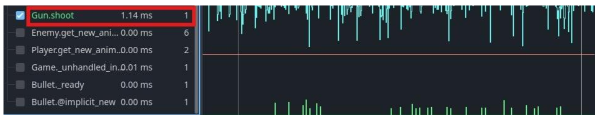
Figura 24 – Tempo de execução da função “shoot” antes da implementação do pooling.
