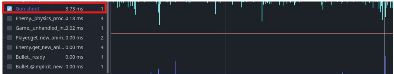
Figura 25 - Tempo de execução da função “shoot” após a implementação do pooling.
