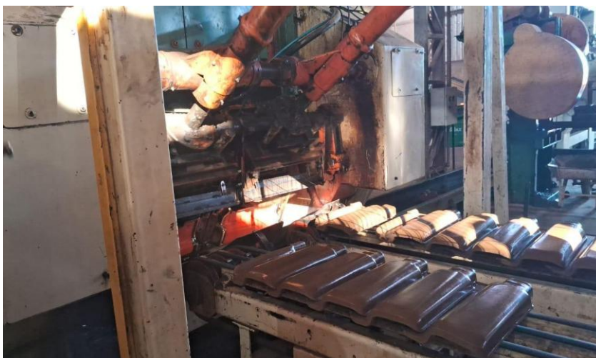
Figura 6 - Processo de conformação de telhas cerâmicas.
