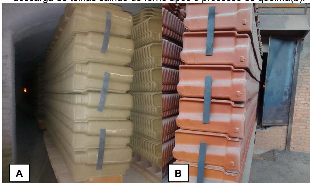
Figura 8 - Carga de telhas cruas entrando no forno para o processo de queima(a), descarga de telhas saindo do forno após o processo de queima(b).
