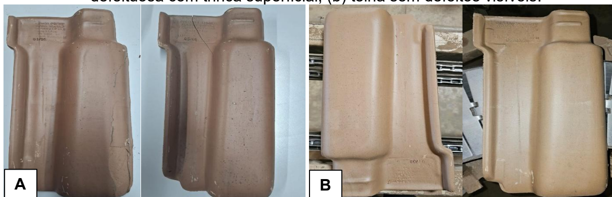
Figura 26 - Amostras representativas das classes utilizadas no estudo: (a) telha defeituosa com trinca superficial; (b) telha sem defeitos visíveis.
