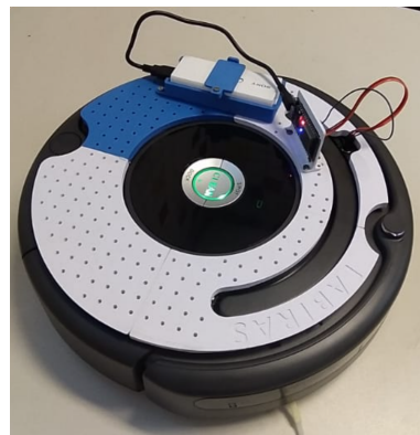
Figura 22 – Roomba montado com ESP 32, bateria e a base para adição de sensores variados.
