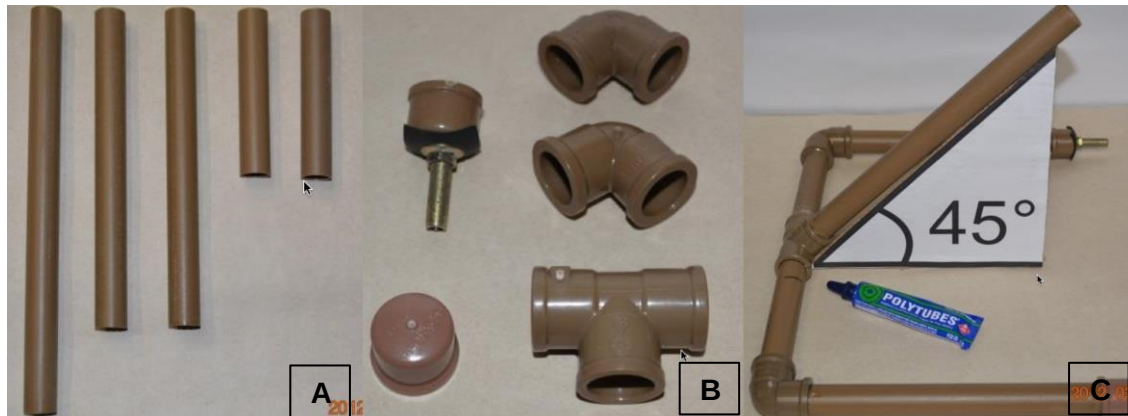
FIGURA 2 – TUBOS DE CONEXÕES DE PVC UTILIZADOS NA CONFEÇÃO DA BASE DE LANÇAMENTO DOS FOGUETES.
