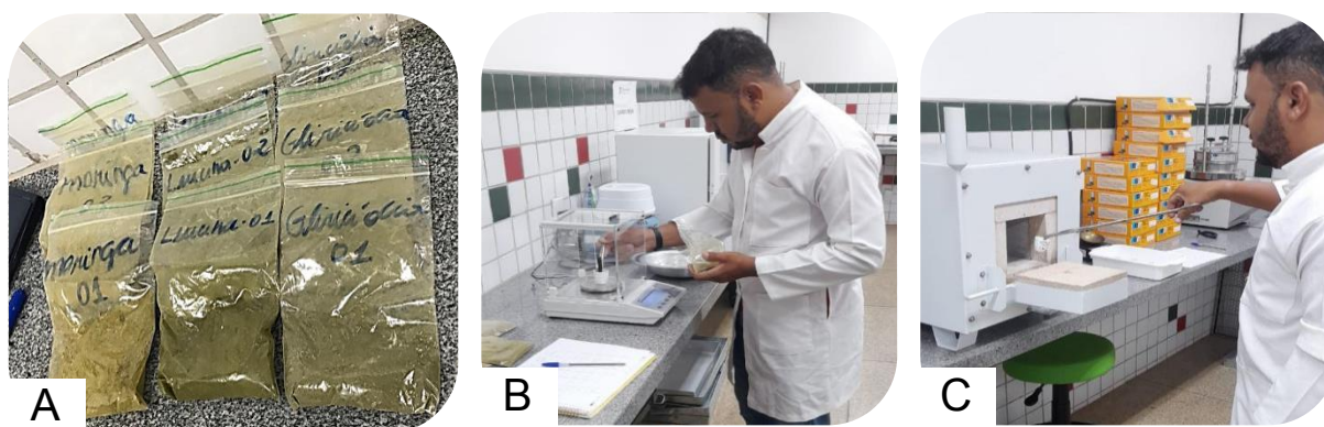
A – Amostras identificadas; B - Pesagem das amostras em balança analítica; C - Amostras em forno mufla para a determinação da matéria mineral
