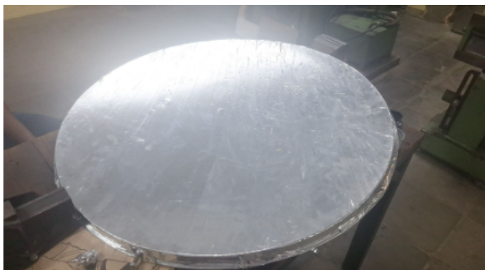
Figura 9 - Aplicação de fita reflexiva na antena parabólica
