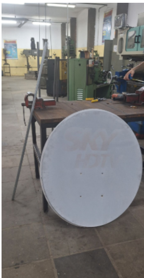
Figura 7 - Antena parabólica utilizada fazer o fogão solar
