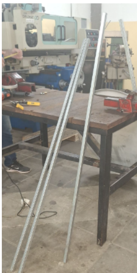
Figura 6 - Barras de metalon usadas para fazer a base fogão solar
