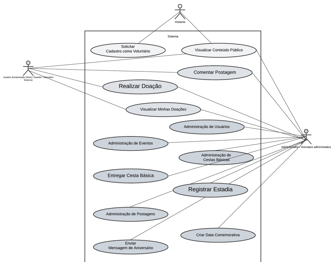
Figura 6 – Diagrama de Caso de Uso UML
