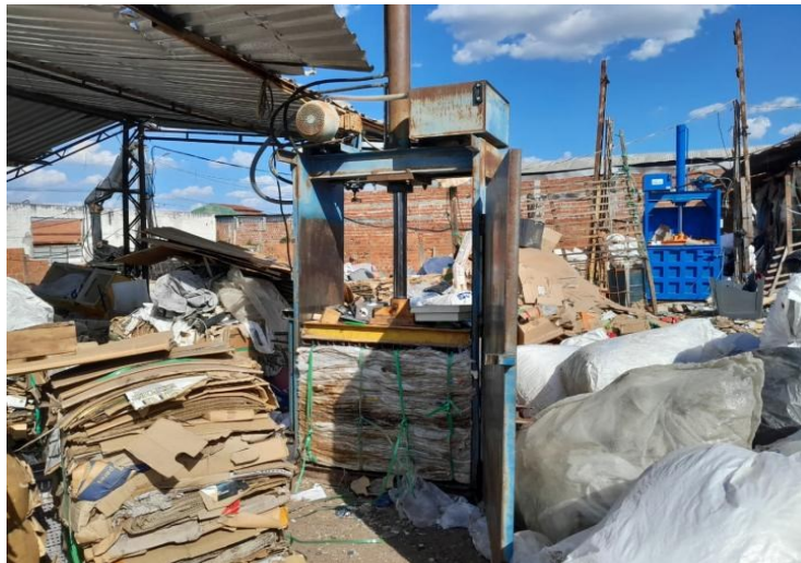
Figura 5 – Prensas enfardadeiras utilizadas para a compactação de papel, papelão e plástico após a triagem
