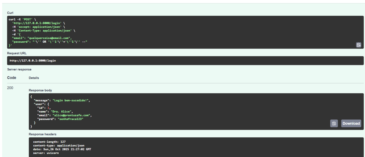
Figura 4 – Resultado bem-sucedido do ataque de bypass de autenticação.
