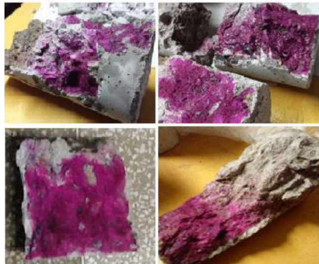
Figura 15 - Exemplo do aspecto das amostras após aspersão de fenolfatelina
