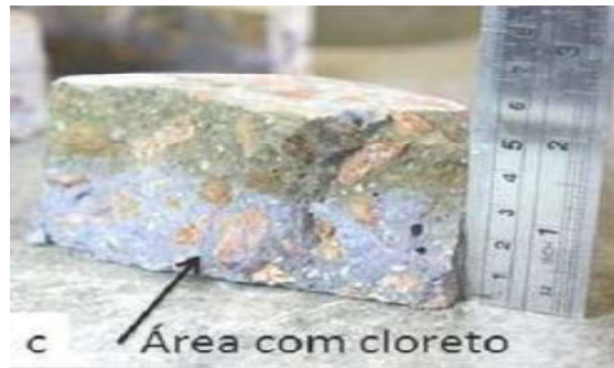
Figura 17 - Medição da profundidade de penetração de cloretos por meio da aspersão de uma solução de nitrato de prata ( \text{AgNO}_3 )
