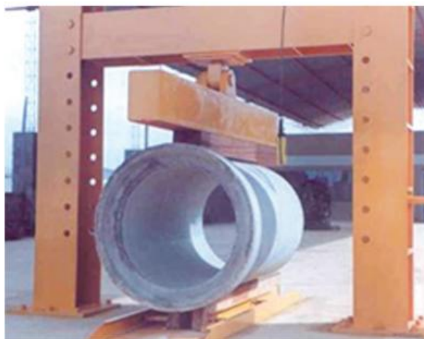
Figura 23 – Ensaio de resistência à compressão diametral
