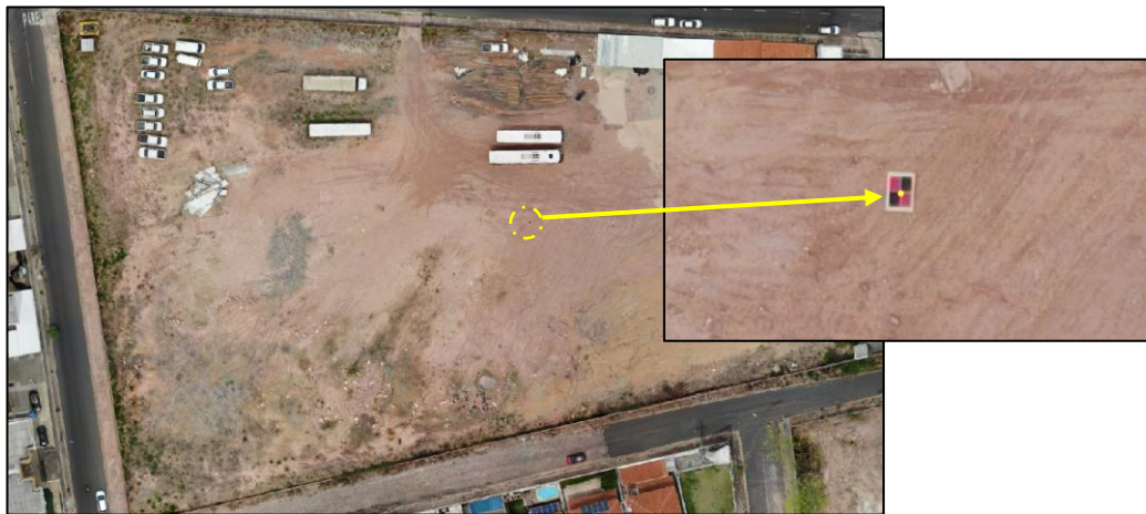
Figura 2 – obtenção das coordenadas na ortofoto a partir do software QGIS.
