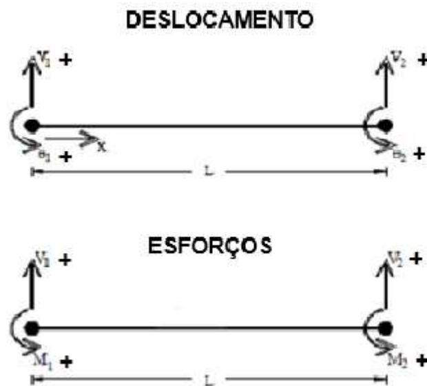
Figura 7 - Padrões adotados para sentido de deslocamento do elemento de viga para aplicação do MEF.
