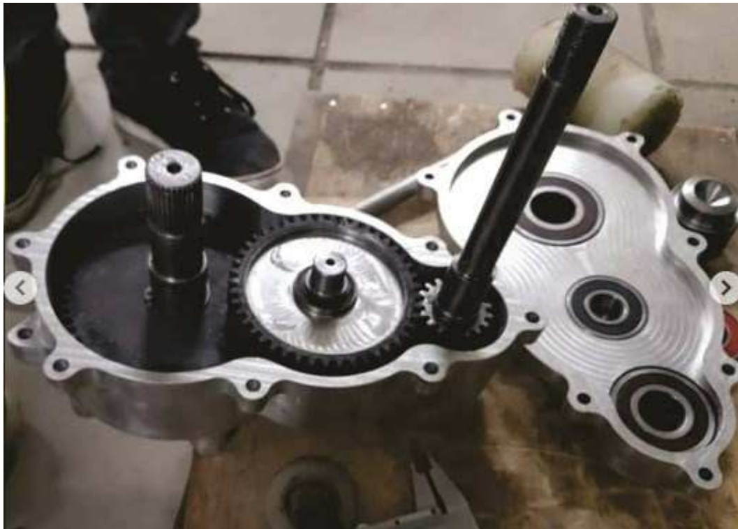
Figura 12 - Caixa de redução do sistema de transmissão do potótipo Baja.
