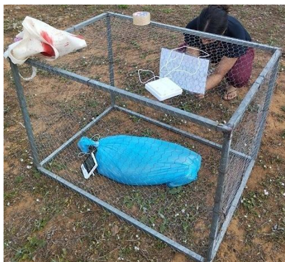
Figura 4 -Gaiola construída em ferro e tela metálica
